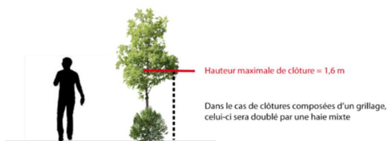
Clôture principalement composée d'un grillage
