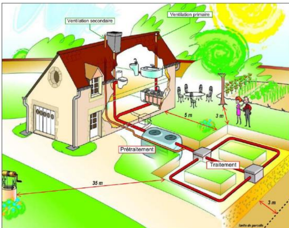
Figure 10 : Schéma de principe de l'assainissement non collectif
