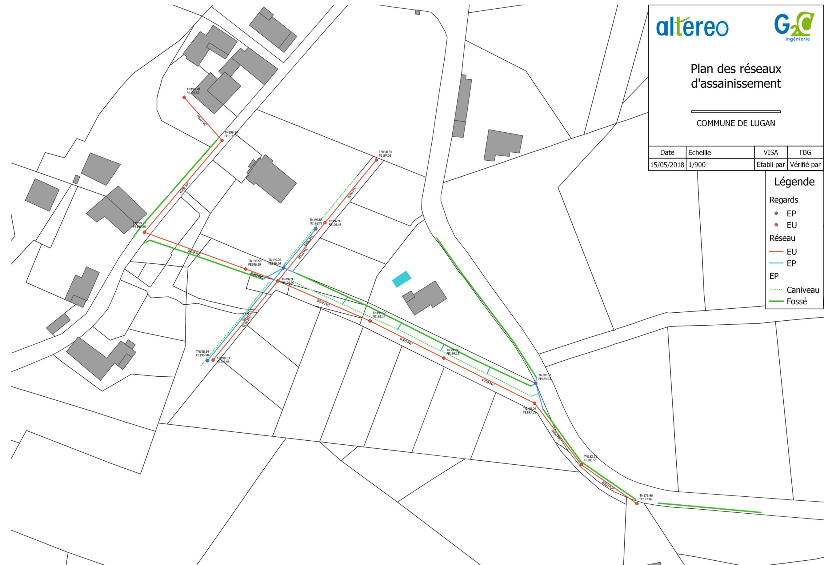
Figure 4: Plan des réseaux d'assainissement de Lugan
