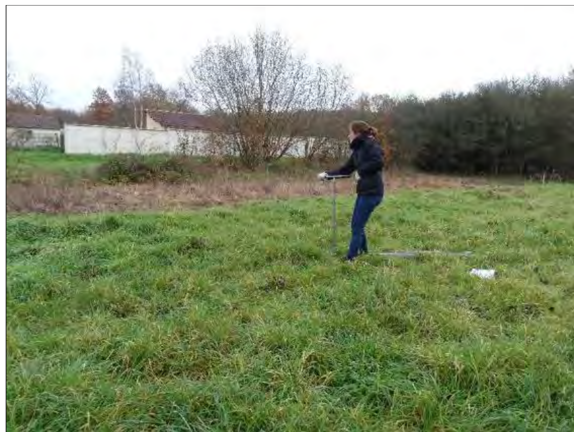
Sondage à la tarière manuelle
