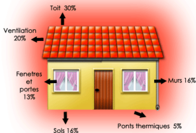
Figure 107 : Déperdition de chaleur d'un habitat non isolé
