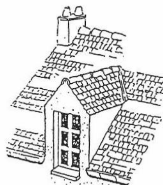
Les lucarnes à bâtière
