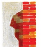
mur ancien en brique réduit au plâtre au ravaud
