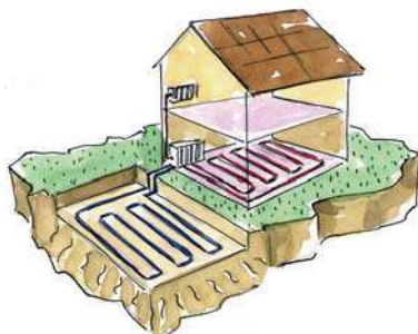
Capteurs horizontaux enterrés à environ un mètre
