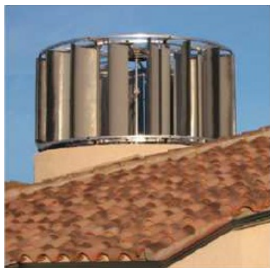
Aérogénérateur à axe vertical
