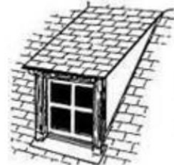
lucarne rampante ou en chien couché
