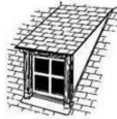
lucarne rampante ou en chien couché
