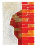
mur ancien en brique enduit au plâtre au ravaud
