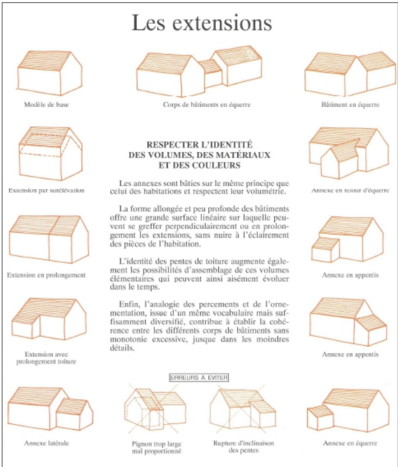
Schéma 4 : Respect des volumes (Source : la Maison rurale d'Ile de France - P. THIEBAUD)
