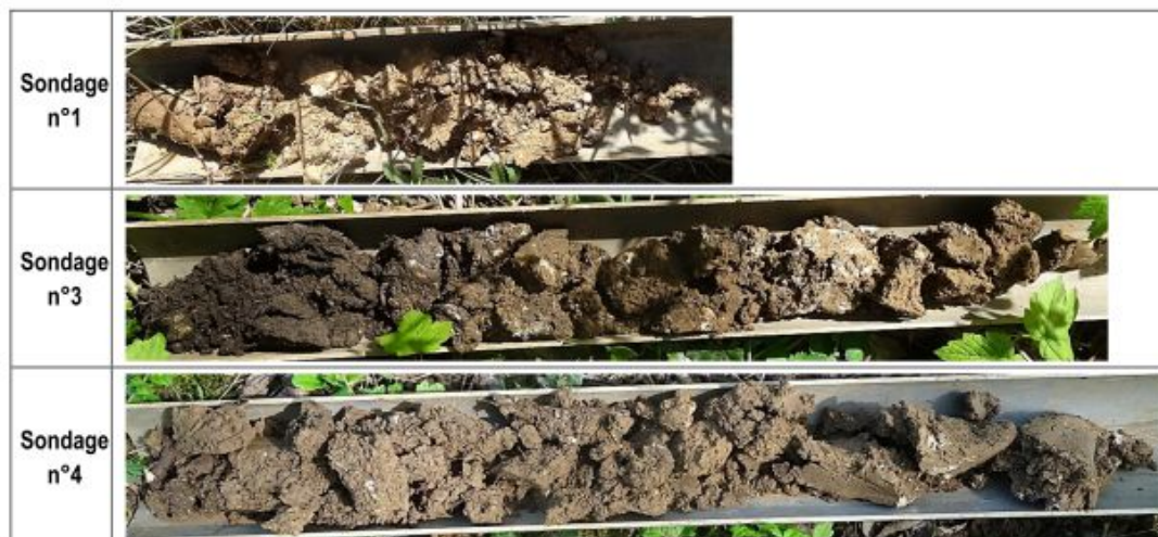
Figure 18 : Sondages réalisés le 20 avril 2022 (du moins profond (à g.) au plus profond (à dr.))
