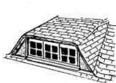
lucarne en trapèze ou rampante à jouées biniées (couverture en bardeaux d'asphalte)
