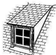
lucarne rampante ou en chien couché
