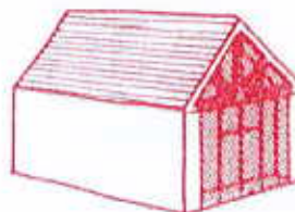
Pignon charpenté vitré
