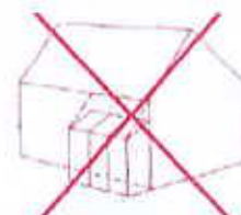
Pente de toit trop faible, ne respectant pas celle de la maison
