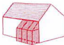
Vérande avec toit prolongeant la toiture
