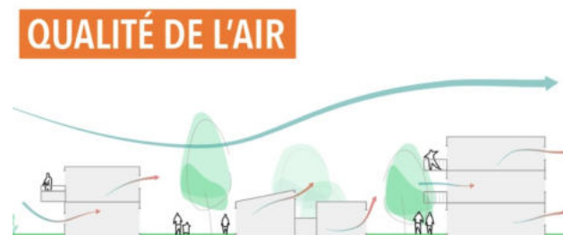
Principe : prendre en compte les vents dans l'implantation des bâtiments pour permettre une ventilation naturelle
