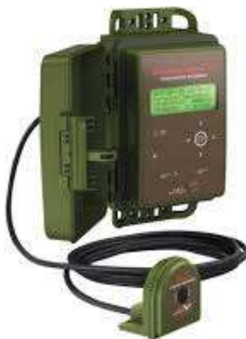
Enregistreur automatique SM4 bat full spectrum
