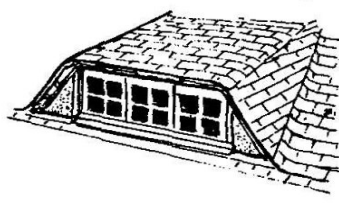
lucarne en trapèze (couv. bardeaux d'asphalte)
