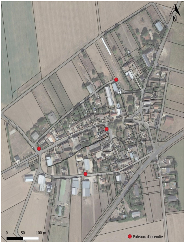
Localisation des poteaux de défense incendie - Source : Mairie
