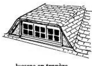
lucarne en trapèze ou rampante à jouées biaisées (couverture en bardeaux d'asphalte)
