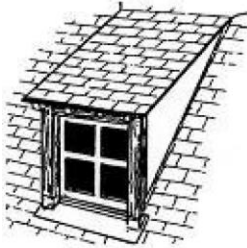
lucarne rampante ou en chien couché
