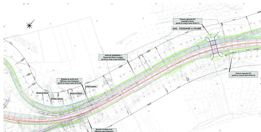
Élargissement de ma RD1206 en 2 fois 2 voies et création d'un passage faune
