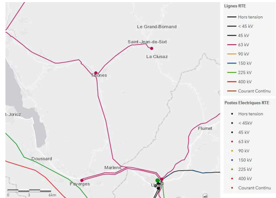
Réseau des postes et lignes électriques sur le territoire intercommunal (Source : RTE)
