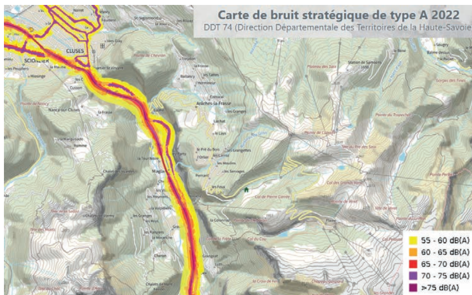
Zones d'exposition au bruit identifiées par les cartes stratégiques de bruit sur la commune - Lden 24h - Source : DDT 74
