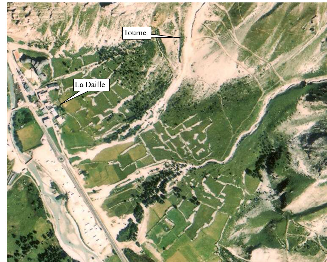
Fig. 2 : dépôts de laves torrentielles issues des ruisseaux du Franchet (en haut) et de la Bouclia ou Rua (en bas), sur photo aérienne de 1996, quelques jours après la crue du 24 juillet 1996 (photo IGN).
