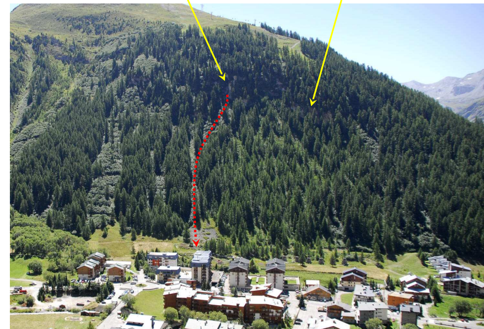
Fig. 3 : vue générale du site en 2012 et trajectoire principale de l'éboulement des années 80 (photo RTM73).
