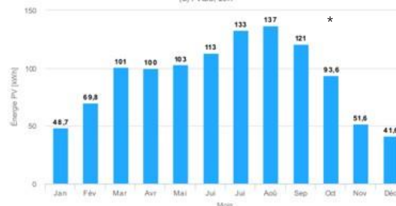
Production énergétique mensuelle du système PV fixe (C) PVGIS, 2017
