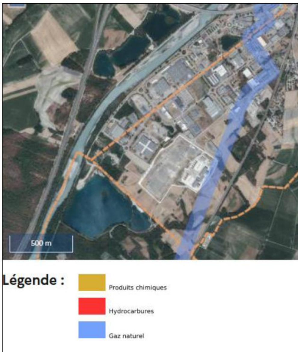
Tracé des canalisations de transport de gaz
