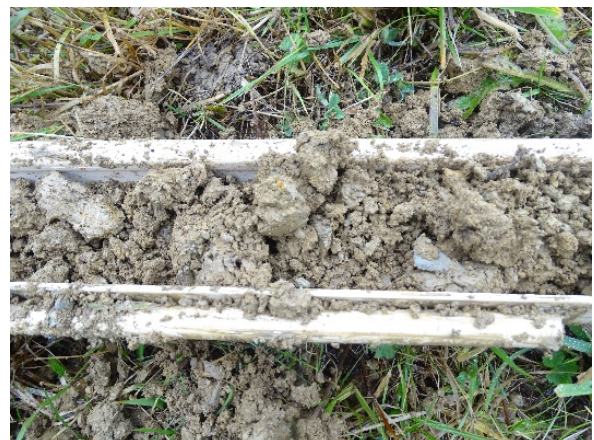
OAP5_3 : présence importante de cailloux
