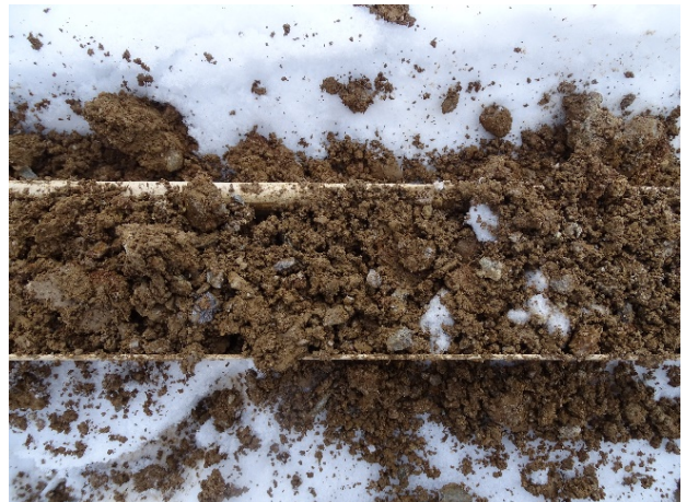
OAP7_1 : présence de nombreux graviers de remblais
