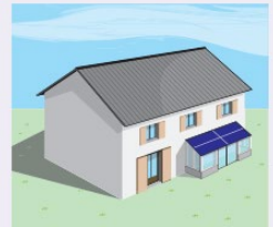
Les capteurs couvrent la totalité du pan de toiture de la serre
