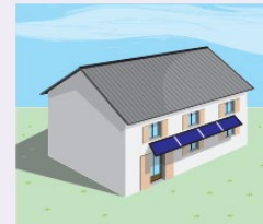
Les capteurs forment un auvent qui crée une ombre portée sur les fenêtres du rez-de-chaussée en été
