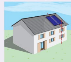
Le petit capteur en toiture est placé dans l'axe des fenêtres existantes
