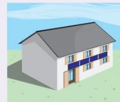
Les capteurs disposés en bandeau vertical ont la même largeur que l'ensemble des fenêtres de l'étage
