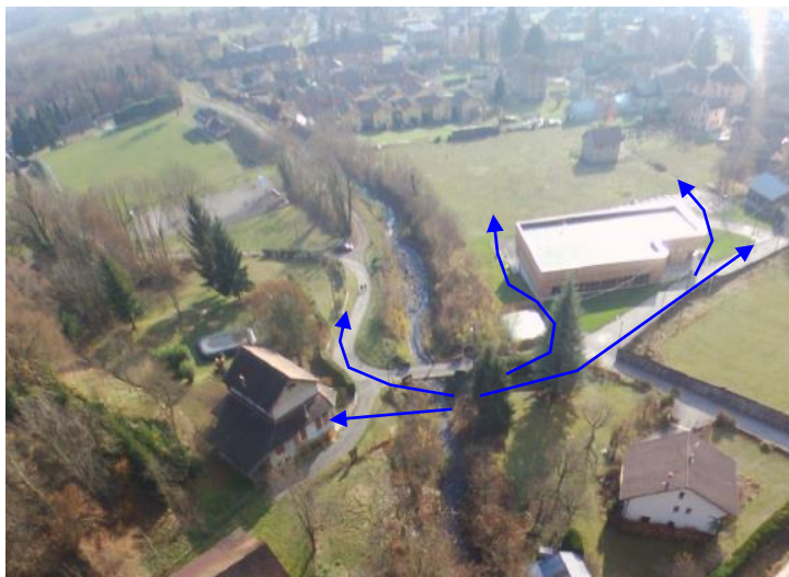
Figure 6 : Débordements possibles sur le pont de la rue de l'église en cas d'embâcle (ETRM)
