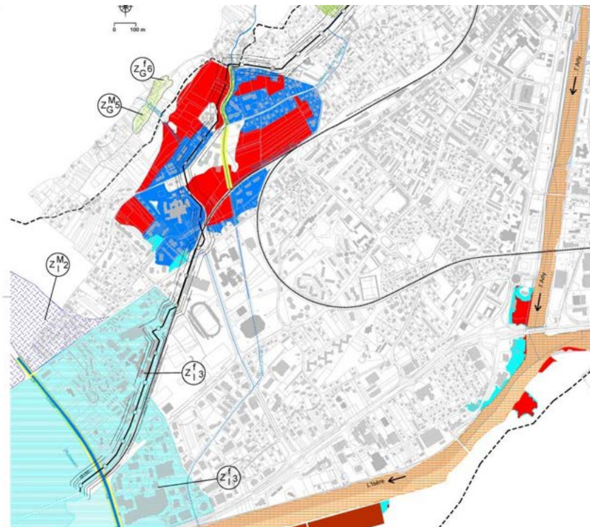
Carte 16 : synthèse des risques et aléas naturels (source PLU). les zones rouges et bleues en amont du projet correspondent à la situation identifiée générée par le ruisseau du Nant Pottier (zone d'expansion principalement).
