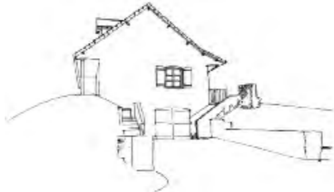
Le mauvais exemple ci-dessus montre une saignée très importante pratiquée dans le sol pour accéder à un garage inférieur. Ces mouvements de terrains sont coûteux. Mieux vaut tout réaliser sur un seul niveau en adossant le garage à la maison sous un même toit, un peu à la manière des extensions opérées sur l'habitat traditionnel.
