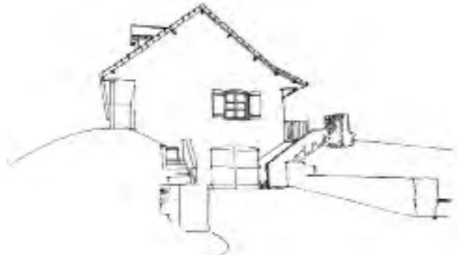
Le mauvais exemple ci-dessus montre une saignée très importante pratiquée dans le sol pour accéder à un garage inférieur. Ces mouvements de terrains sont coûteux. Mieux vaut tout réaliser sur un seul niveau en adossant le garage à la maison sous un même toit, un peu à la manière des extensions opérées sur l'habitat traditionnel.
