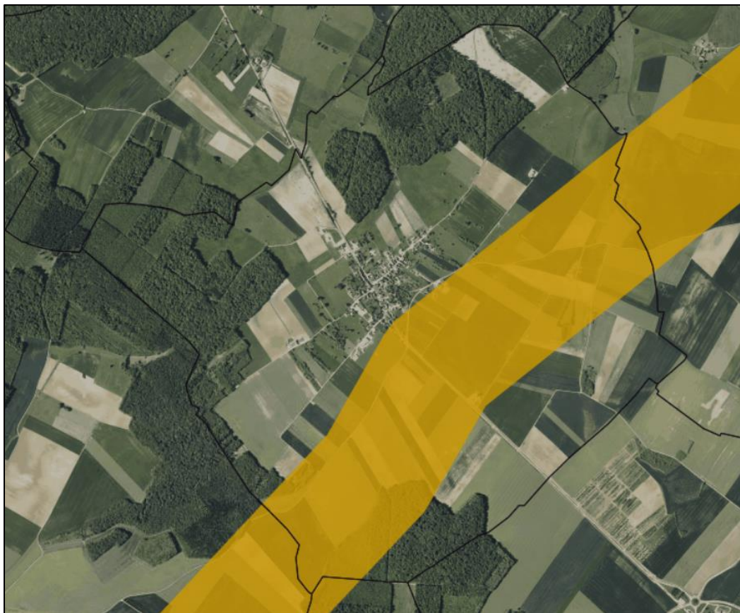
Figure 17 : Servitude liée à la canalisation de transport de produits chimiques
