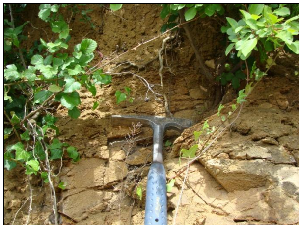
Figure 4 : Affleurement de leptynites surmonté d'une couverture d'altération dans le secteur du Mont ( limite roche saine / altérée nettement visible au niveau de la tête du marteau, photo de droite ) [Source : IMS RN ]
