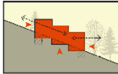
Principe d'implantation dans la pente et de réduction des terrassements.
