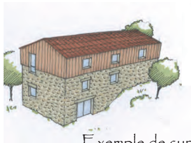
Exemple de surélévation
