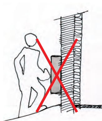
Élément non intégré à la façade
