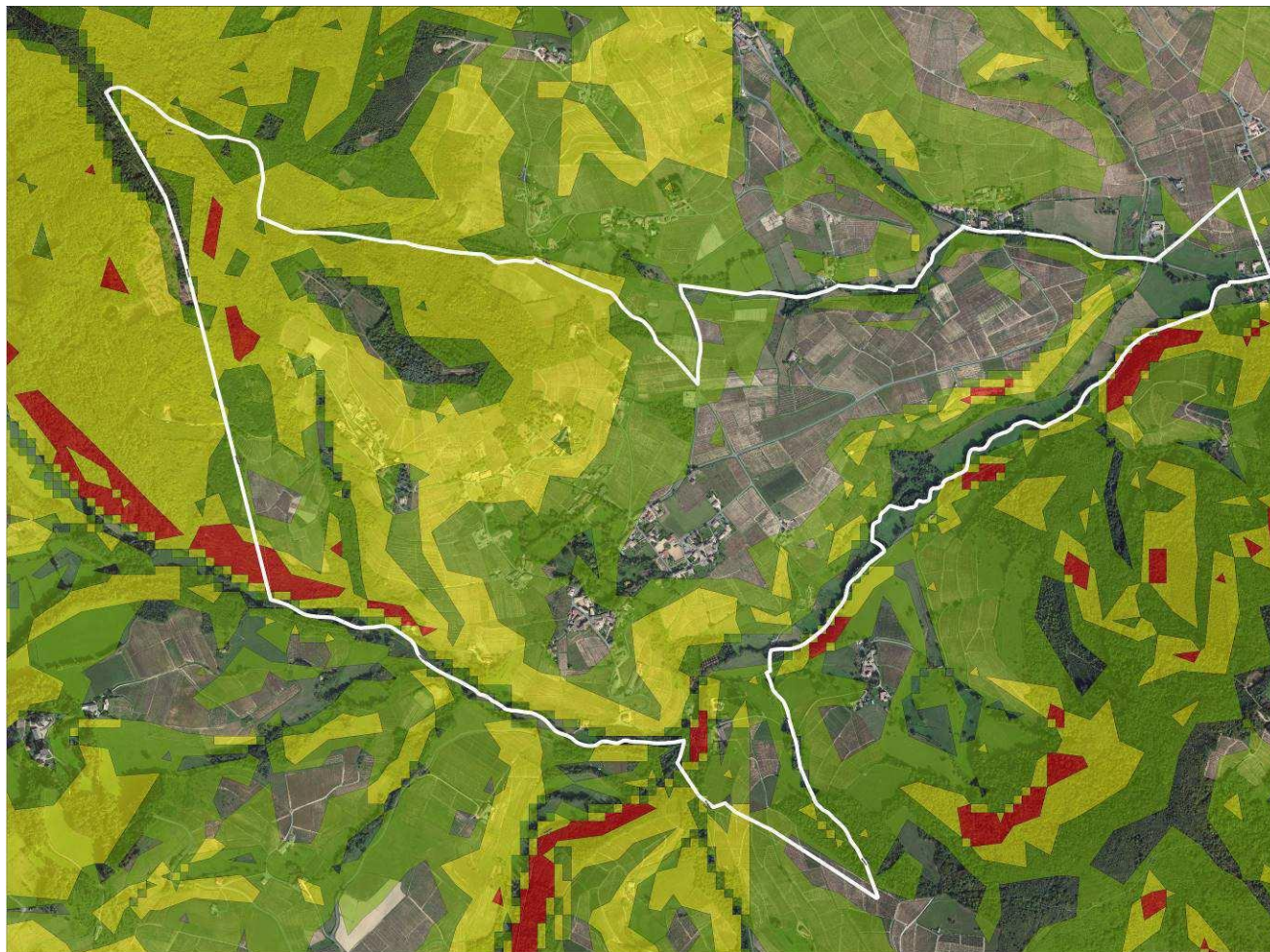
Extrait de la carte des susceptibilités aux « mouvements de terrain » (source : BRGM)
