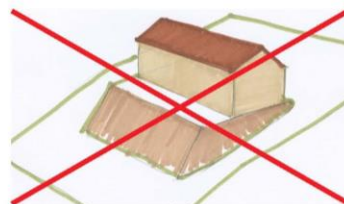
Exemple de mouvement de sol proscrit
