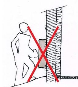
Élément non intégré à la façade
