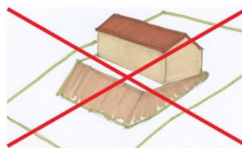
Exemple de mouvement de sol proscrit
