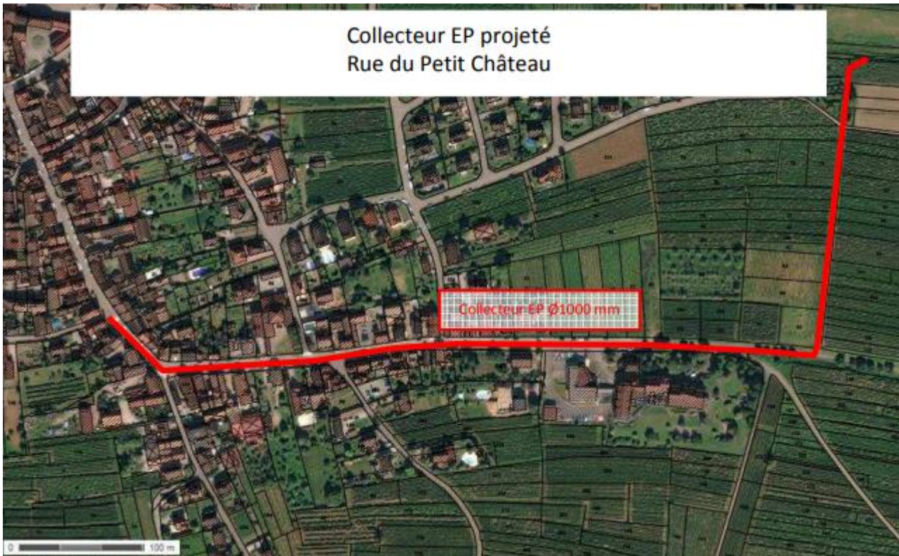
Figure 59 : Collecteur EP projeté Rue du Petit Château - IRH Ingénieur conseil
