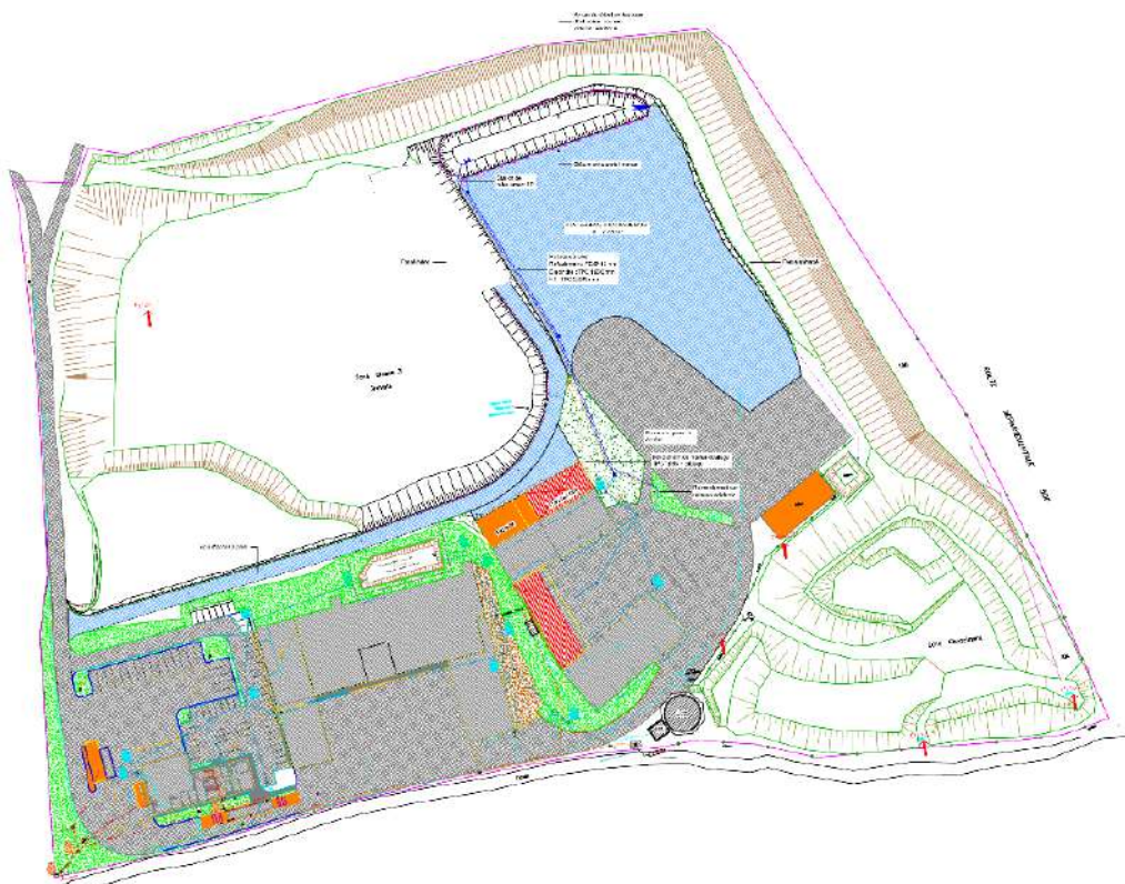
Figure 1: schéma de aménagements prévus. En bleu : nouvelle voie d'accès et plateforme enrobée (déchets verts et bois). En rouge : nouvel auvent de protection des intempéries.
