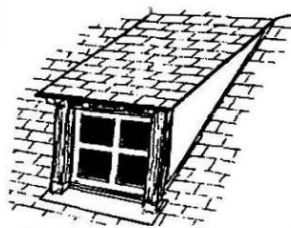
lucarne rampante ou en "chien couché"
