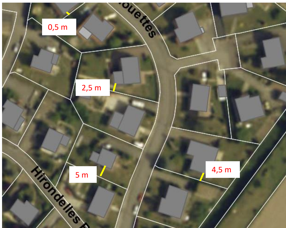
Implantation par rapport aux limites séparatives, rue des Alouettes
