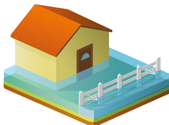
Figure 4 : Exemple de clôture assurant la transparence hydraulique. Source : Mayane pour la DDT du Bas-Rhin, 2017.
