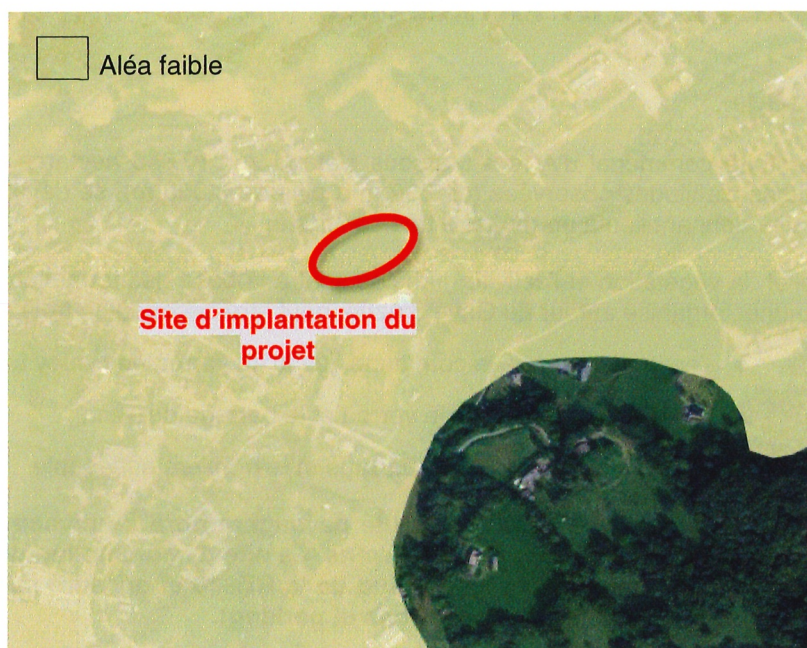
Fig. 14. Identification du risque retrait-gonflement des argiles à hauteur du projet
