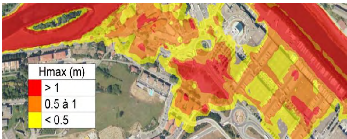
Figure 40 : Hauteur d'eau maximale simulée dans le quartier de Béhobie lors de l'évènement de février 2009.
