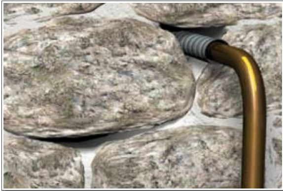
Situation initiale avant colmatage
