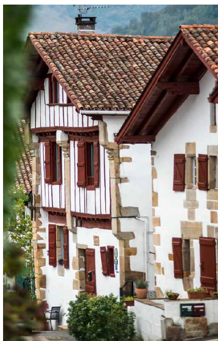
Etxe basques, où le faîtage est parallèle à la plus grande longueur du volume principal de la construction
