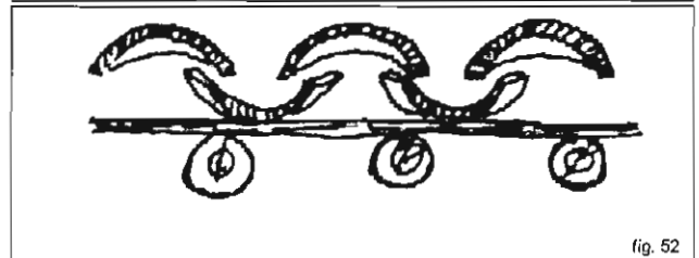
fig.51-52 : Tuile canal, pose sur volige
