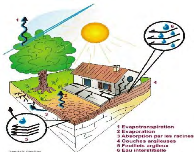
fig. 1 : illustration du mécanisme de dessiccation
