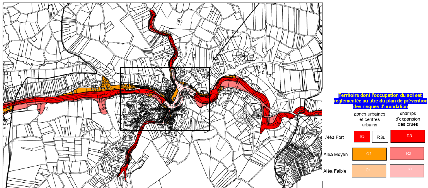
Carte d'aléa fort, moyen et faible d'inondation, réalisée dans le cadre du PPRNPI 2008
