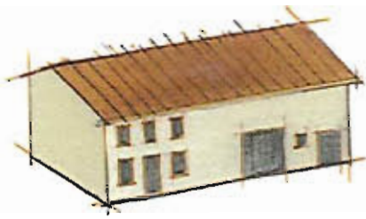
La ferme bloc en long, modèle le plus répandu, où les bâtiments d'activités prolongent le logement et composent un seul volume sous un toit à deux pans.
