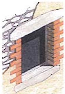
Les encadrements d'ouvertures, conçus en légère saillie sont destinés à bloquer l'enduit.
