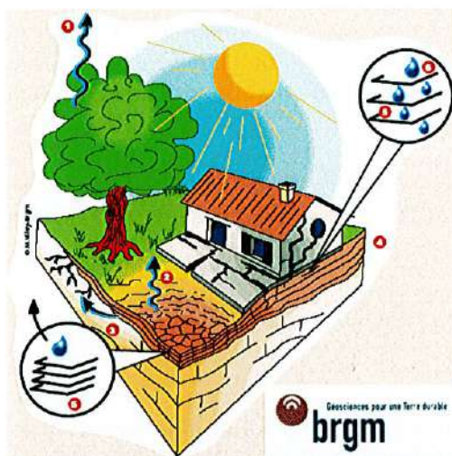
Schéma illustrant le fonctionnement de l'aléa retrait/gonflement des argiles
